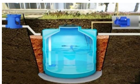
Figura 2.4-28: Imagem ilustrativa da instalação da cisterna próximo as áreas dos separadores de água e óleo
