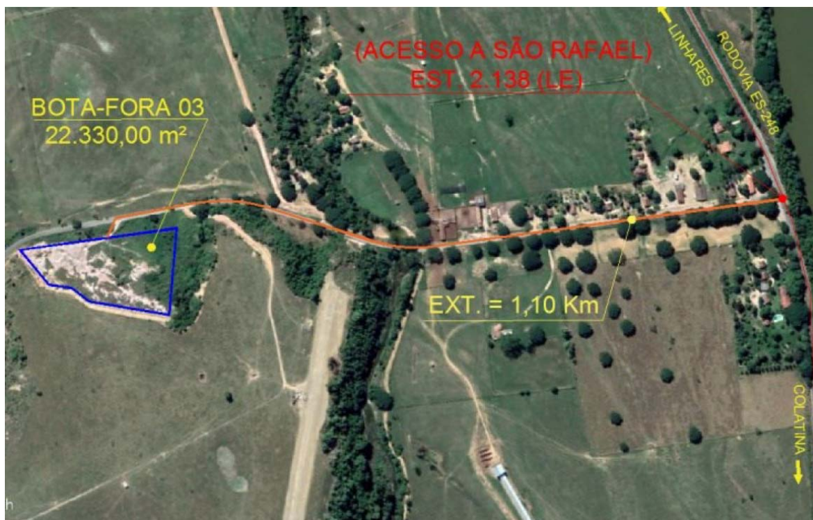
Figura 20 – Área a ser Ocupada para o Bota-fora 03 e Acesso
