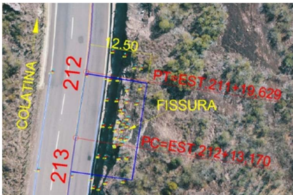
Figura 30 – Rocha Fraturada – Estaca 212 a 213 – ES 248 (Lado Esquerdo)
