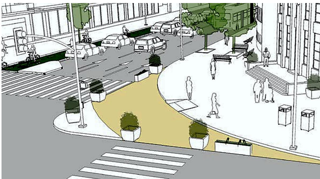
Figura 38: Remoção de faixas de conversão
